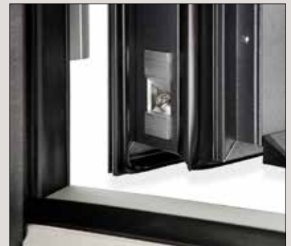
Eckverbindungen äußerst stabil, Profile auf Gehrung verschraubt, verklebt und verbolzt
